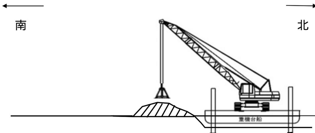
伊目航路の南側に横振りした土砂を浚渫し、東名高速道路を超えた水深の深い区域に土砂を投下します。
