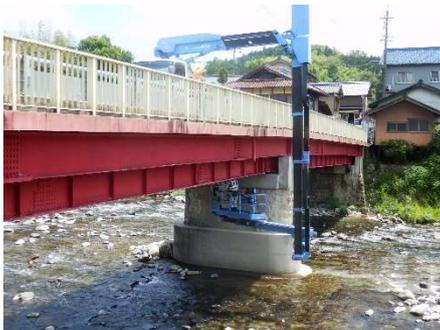
写真-2 橋梁点検車(BT-200)使用状況
