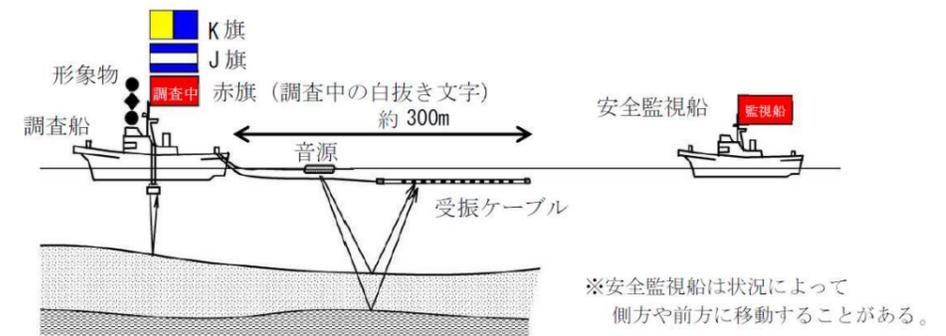
図-4 音波探査模式図
