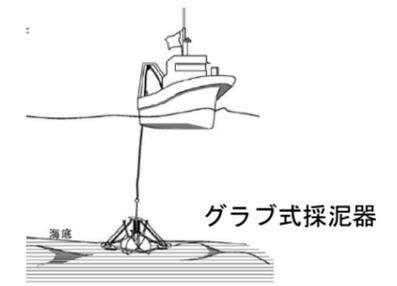
図-3 海底試料採取模式図
